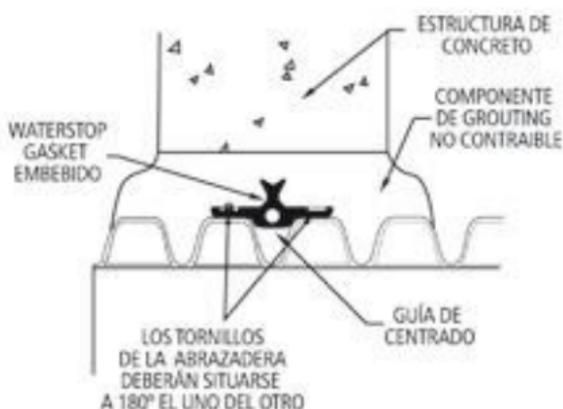
Nunca deje la campana inserta en la pared de la estructura de concreto. Esta debe ser previamente eliminada. Está permitido que la espiga del tubo quede embebida en el hormigón.
