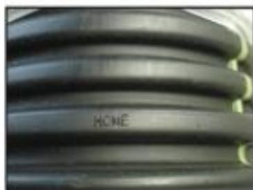
Cuando la tubería cuente con refuerzo de cerámica (cinta de color verde) en su campana, éste siempre debe quedar situado sobre el empaque o goma al realizar la unión.
