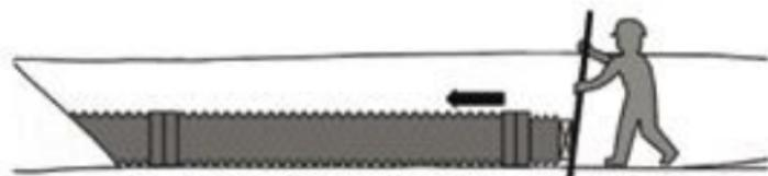
Método de Instalación con Excavadora (recomendado para instalación de tuberías desde 600 mm (24")).
